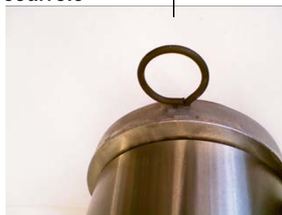
Figure 3 Version 2 - Retirer la goupille après la pose de la courroie
